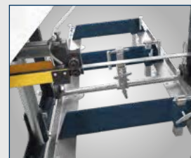
Regulowane prowadniki taśmy ułatwiają precyzyjne cięcie.
