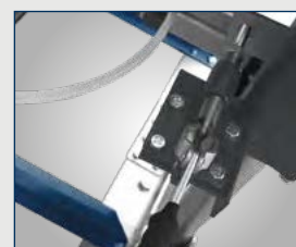
Wysokość cięcia blokowana za pomocą dźwigni znajdującej się po obu stronach
