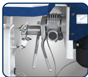
KSO 150 M Agregat szlifierski przechylany do 45° za pomocą dźwigni.
