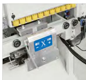
Pneumatyczny ogranicznik pozycjonowanego elementu
