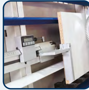
► Cyfrowy wyświetlacz do ustawienia wymiaru przy cięciu pionowym
