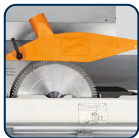
Podwójnie mocowany agregat pilarki
