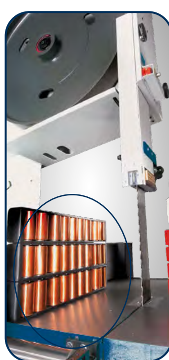
Prowadnica materiału z mosiężnymi rollami
