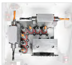
Głowica wiertarska wyposażona w pionowe i poziome wrzeciono umożliwia dużą elastyczność podczas produkcji
