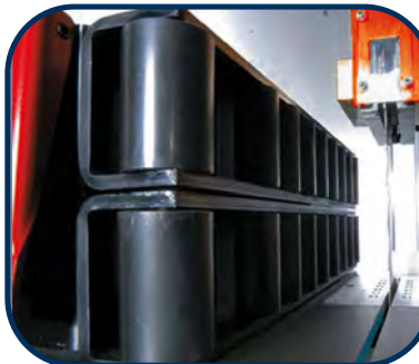
Górne prowadzenie taśmy piłującej z wkładką wykonaną z brązu
