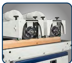
▶ Agregaty robocze mogą być uruchamiane indywidualnie
