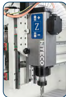
▶ Wysokiej jakości wrzeciono frezujące od sprawdzonego producenta Hiteco.
