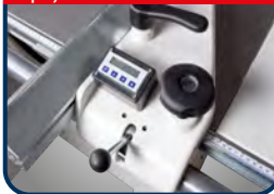
Cyfrowy wyświetlacz przykładnicy cięcia równoległego ▶ Zasilane przez baterię ▶ Z dokładnością 1/10 mm nr art.: 5516000
