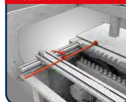
► Przyrząd do precyzyjnego ustawiania tylnej przykładnicy (Nr art. 5302303)
