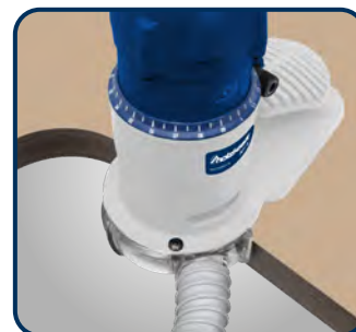
Frezowanie krawędzi płyty.
