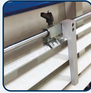
► Linia do ustawienia wymiaru przy cięciu pionowym
