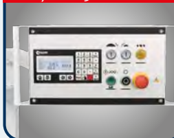
Cyfrowy wyświetlacz przykładnicy cięcia równoległego ▶ Zasilane przez baterię ▶ Z dokładnością 1/10 mm nr art.: 5516000
