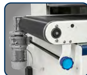
▶ Bezstopniowa regulacja prędkości posuwu.
