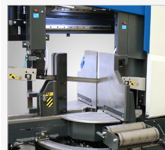
• Stół obrotowy z bocznymi rolkami podtrzymującymi materiał
