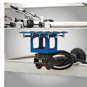
▶ Mocowanie elementu roboczego za pomocą podciśnieniowego urządzenia mocującego
