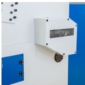
▶ Regulacja szczeliny cięcia za pomocą sterowania NC
