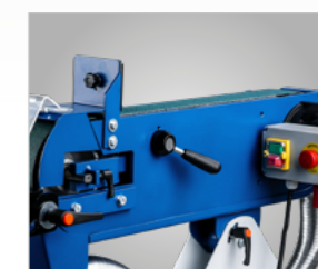
Naprężanie/zwalnianie taśmy za pomocą dźwigni
