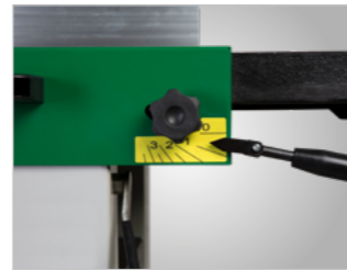
Przestawienie grubości wióra za pomocą dźwigni obsługowej
