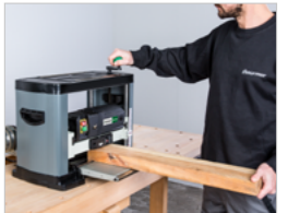
Regulacja wysokości za pomocą korbki ręcznej i skali
