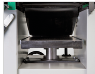
Regulacja stołu grubościówki poprzez pokrętkę ręczną, skalę i wyświetlacz numeryczny
