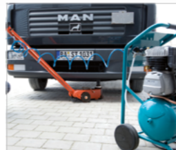
WWH 60000 PH Intuicyjnie obsługiwane pokrętko bezpieczeństwa z przyłączem sprężarki
