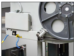
Napędzana szczotka do wiórów do czyszczenia i utrzymania taśmy piły
