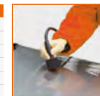
Do naprawy wgnieceń po gradzie bez uszkodzenia lakieru
