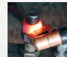
Ogrzewanie nakrętki za pomocą ukośnej cewki ogniskowania
