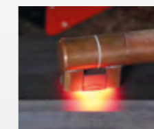
Ogrzewanie elementu za pomocą prostej cewki ogniskowania
