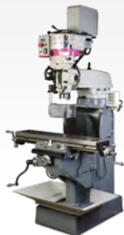
MF 1 VARIO - Wielofunkcyjna wiertarko-frezarka z płynną regulacją obrotów
