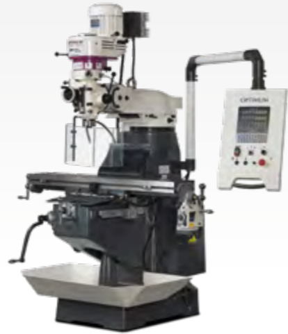
MF 2 VARIO - wielofunkcyjna wiertarko-frezarka z płynną regulacją prędkości obrotowej.
