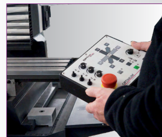
Panel obsługi (Il.: MH 25SV) • Przejrzysty i prosty do obsługi • Duża możliwość dzięki możliwości wyjęcia terminalu obsługi z mocowania (MH 25SV)
