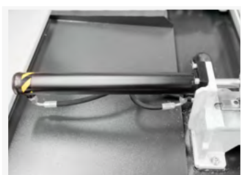
Cylinder z długim skokiem w obu imadłach Korzyść: Krótsze czasy przezbrajania, materiał zawsze pewnie zamocowany
