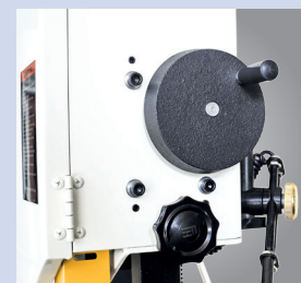
· Regulacja wysokości prowadnicy taśmy za pomocą pokrętła
