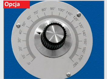
Opcjonalny sterownik PT 1 - wygodna regulacja kąta gięcia potencjometrem z przodu maszyny
