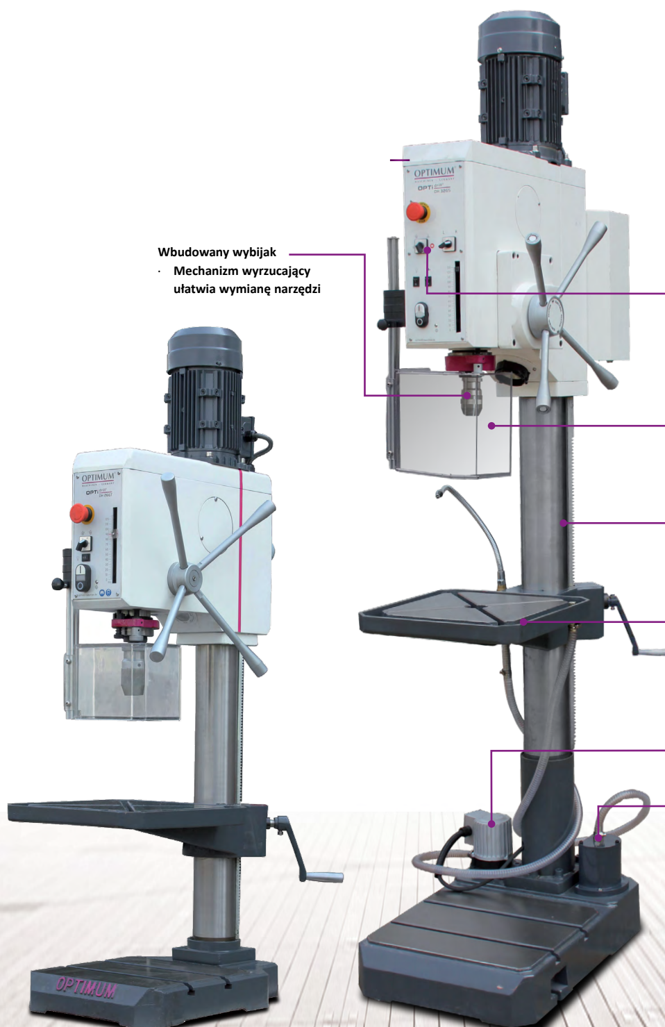
Il.: OPTidril DH 32GS/z opcjonalnym uchwytem wiertarskim
