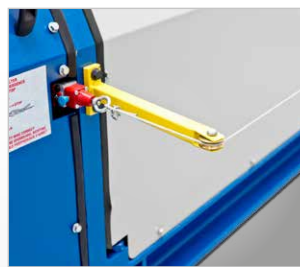
System awaryjnego zatrzymania pracy silnika
