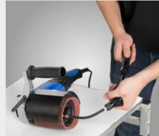
Łatwe mocowanie tulei ściernych poprzez nadmuchiwanie gumowej rolki
