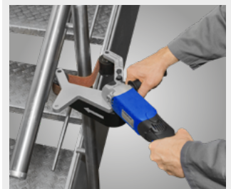
Szczególnie nadaje się do obróbki już zainstalowanych balustrad
