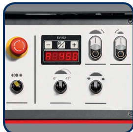
1) Agregat pilarki - Panel sterujący
