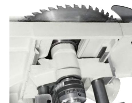
Regulacja pionowa agregatu odbywa się za pomocą pryzmatycznych prowadnic ślizgowych typu jaskółczy ogon.
