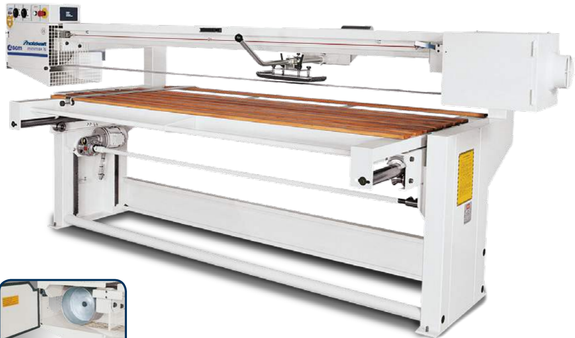
Odpowiednio wyważone rolki zapewnią optymalny napęd taśmy
