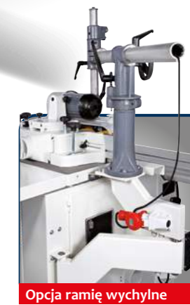
Wychylne ramię z gniazdkiem do VSA do zamontowania aparatu posuwowego
