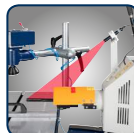
▶ Urządzenie laserowe do oznaczania pozycji wiertła ▶ Standardowo w LLB 56
