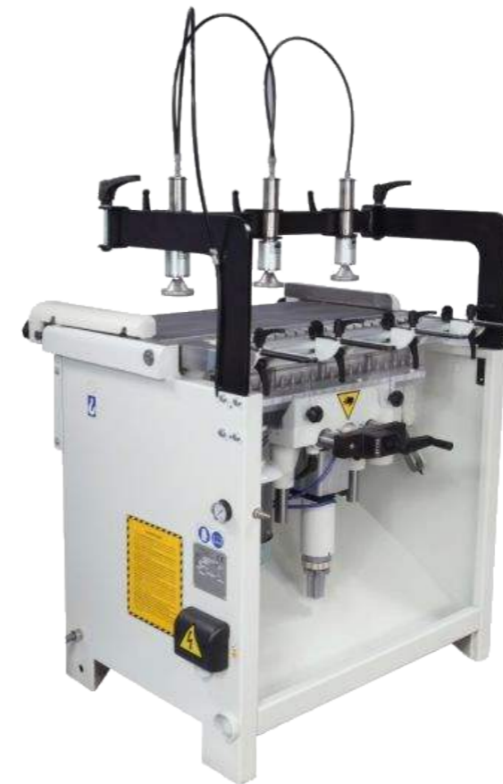
Ustawianie głębokości wiercenia za pomocą 5-pozycyjnego pokrętła rewolwerowego. Regulacja wysokości wiercenia za pomocą pokrętła ze wskaźnikiem mechanicznym. Przechył głowicy wiertarskiej pneumatyczny.
