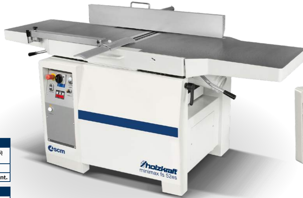
minimax fs 52es TERSA Z elektryczną regulacją wysokości
