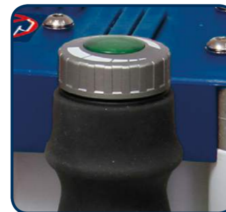
Wygodna bezstopniowa regulacja prędkości posuwu w rękojeści okleiniarki
