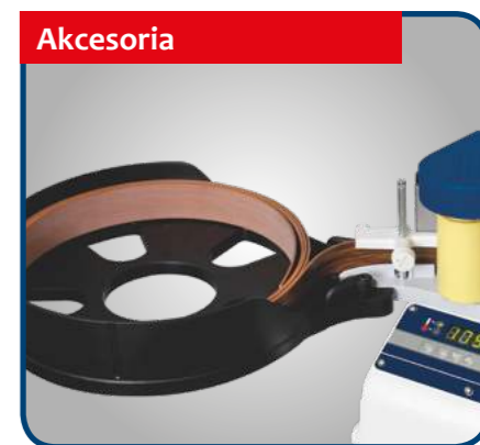
Szybkie ustawianie ogranicznika wysokości obrzeża.
