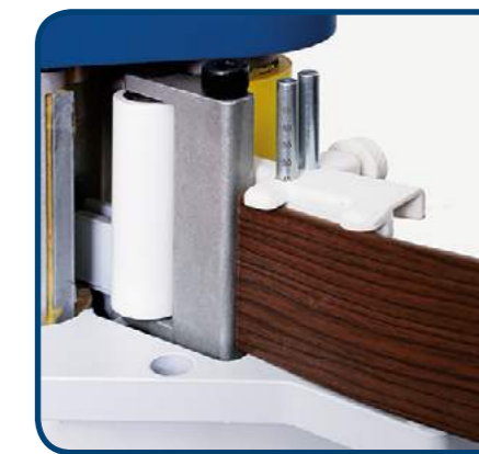
Szybkie ustawianie ogranicznika wysokości obrzeża.
