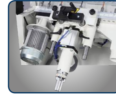
Ustawianie głębokości wiercenia za pomocą 5-pozycyjnego pokrętła rewolwerowego. Regulacja wysokości wiercenia za pomocą pokrętła ze wskaźnikiem mechanicznym. Przechył głowicy wiertarskiej pneumatyczny.
