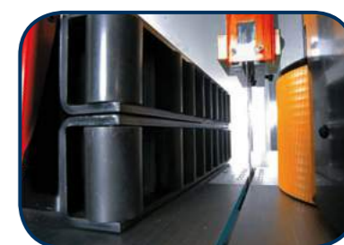
Dolna i górna prowadnica taśmy piłującej z elementami z brązu
