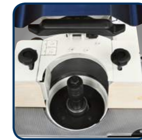
Wysokość użytkowa wrzeczona frezarki 100 mm.
