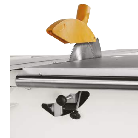
Regulacja tarczy podcinacza odbywa się poprzez pokrętkę od zewnątrz maszyny i umożliwia szybkie, precyzyjne pozycjonowanie bez luzów.
