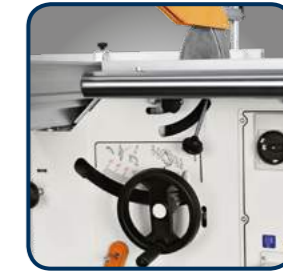
Agregat pilarki z tarczą o maksymalnej średnicy 315 mm
