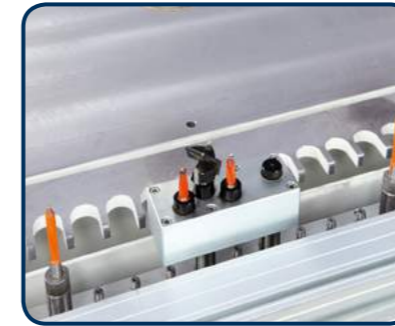
Opcjonalnie dostępny agregat do wiercenia pod zawiasy puszkowe (Blum, Hettich, Mini, Grass, Salice, Mepla do wyboru)
