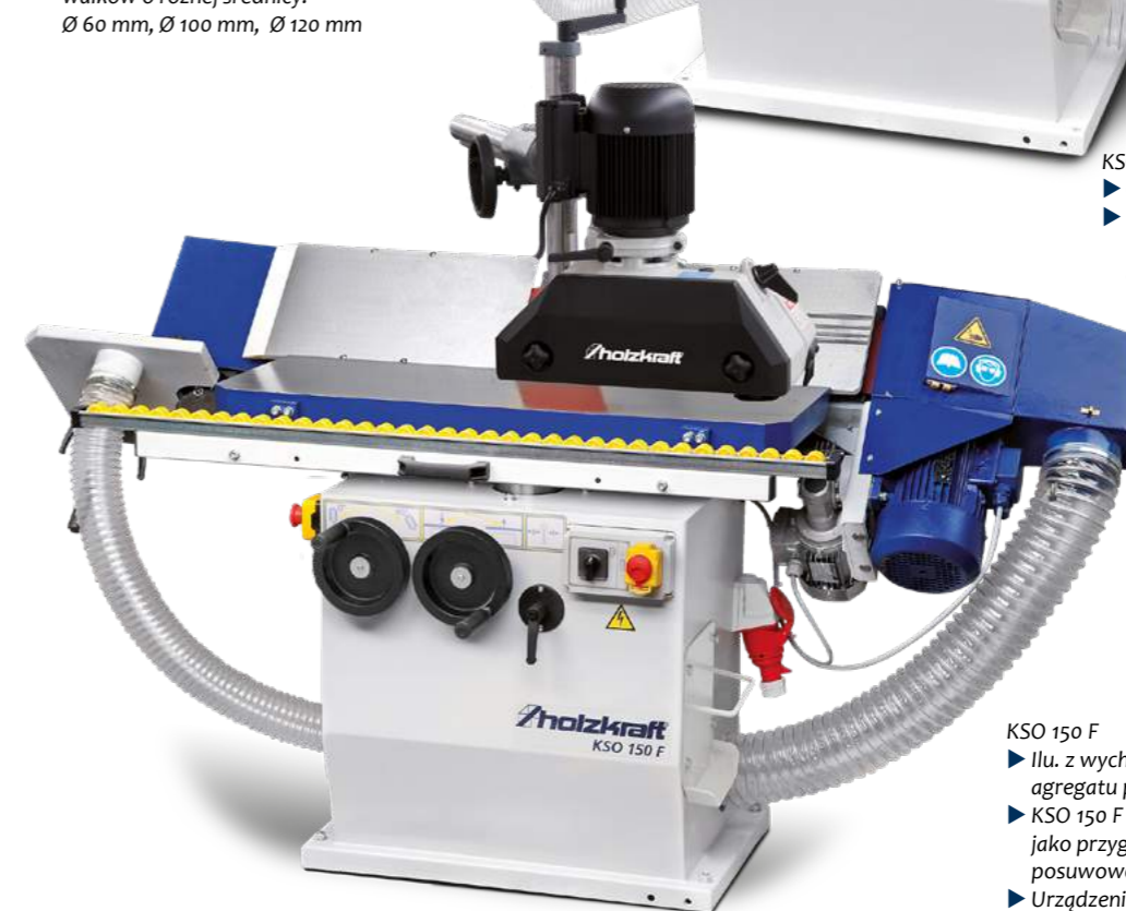
KSO 150 FD z głowicą rewolwerową i obracaną podstawą do szybkiego przezbierania dla 3 wałków o różnej średnicy: Ø 60 mm, Ø 100 mm, Ø 120 mm
