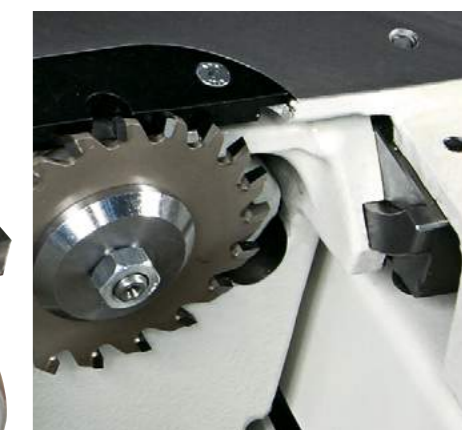
Regulacja pionowa agregatu odbywa się za pomocą pryzmatycznych prowadnic ślizgowych typu jaskółczy ogon.
