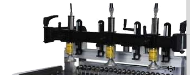
Opcjonalnie dostępna w wersji z 3 dociskami pneumatycznymi.
