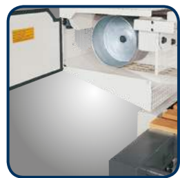
Odpowiednio wyważone rolki zapewnią optymalny napęd taśmy
