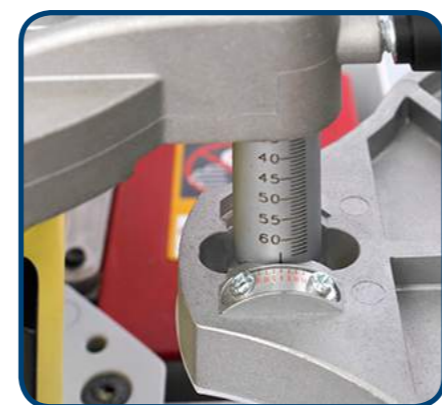
Wysokość elementu 10 - 60 mm odczytywana na skali. Płytę prowadzącą można pochylić o \pm 15^\circ co daje możliwość oklejenia krawędzi pod kątem.
