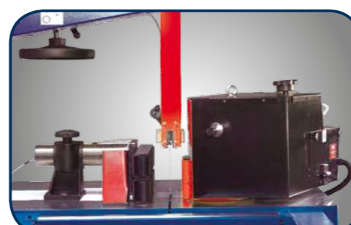
Pneumatyczny z bestopniową regulacją posuwu.
