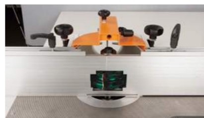
Ilustracja pokazuje regulowane listwy bezpieczeństwa zamontowane na frezarce dolnowrzecionowej.
