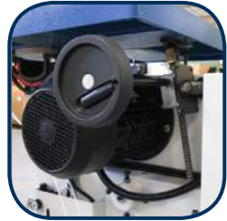
Opcja mechanizm przechyłu stołu z regulacją poprzez listwę zębatą.
